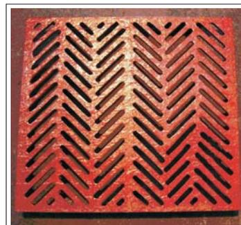
Chapa de desgaste revestida com solda PTA, sem trincas aparentes e com maior uniformidade no acabamento. Durabilidade muito superior às demais chapas revestidas devido à possibilidade de customização da composição química e do processo de deposição.
