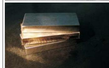
Chapa de aço laminada e temperada, cortada e furada, com dureza de 400 a 700 HB.
