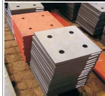
Chapa de desgaste laminada e temperada com parafuso fixado na parte traseira, pronta para aplicação em chute de descarga.
