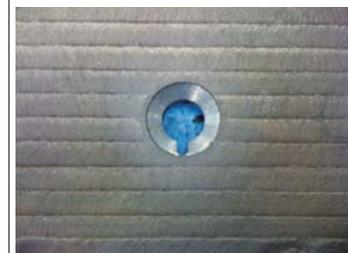
Chapa bimetálica Tungclad, cladeada por explosão em ASTMA36 + AISI D2 temperado, com dureza de 65HRC.
